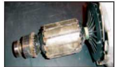
Induit grillé (surchauffe)
