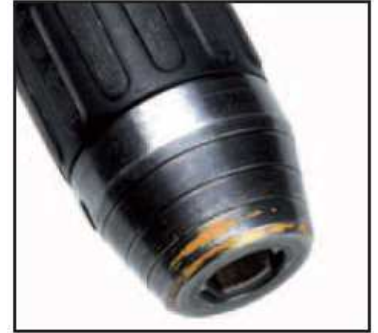
Usure causé par l'utilisation de la perceuse avec le mandrin frottant contre maçonnerie ou d'autres surfaces dures
